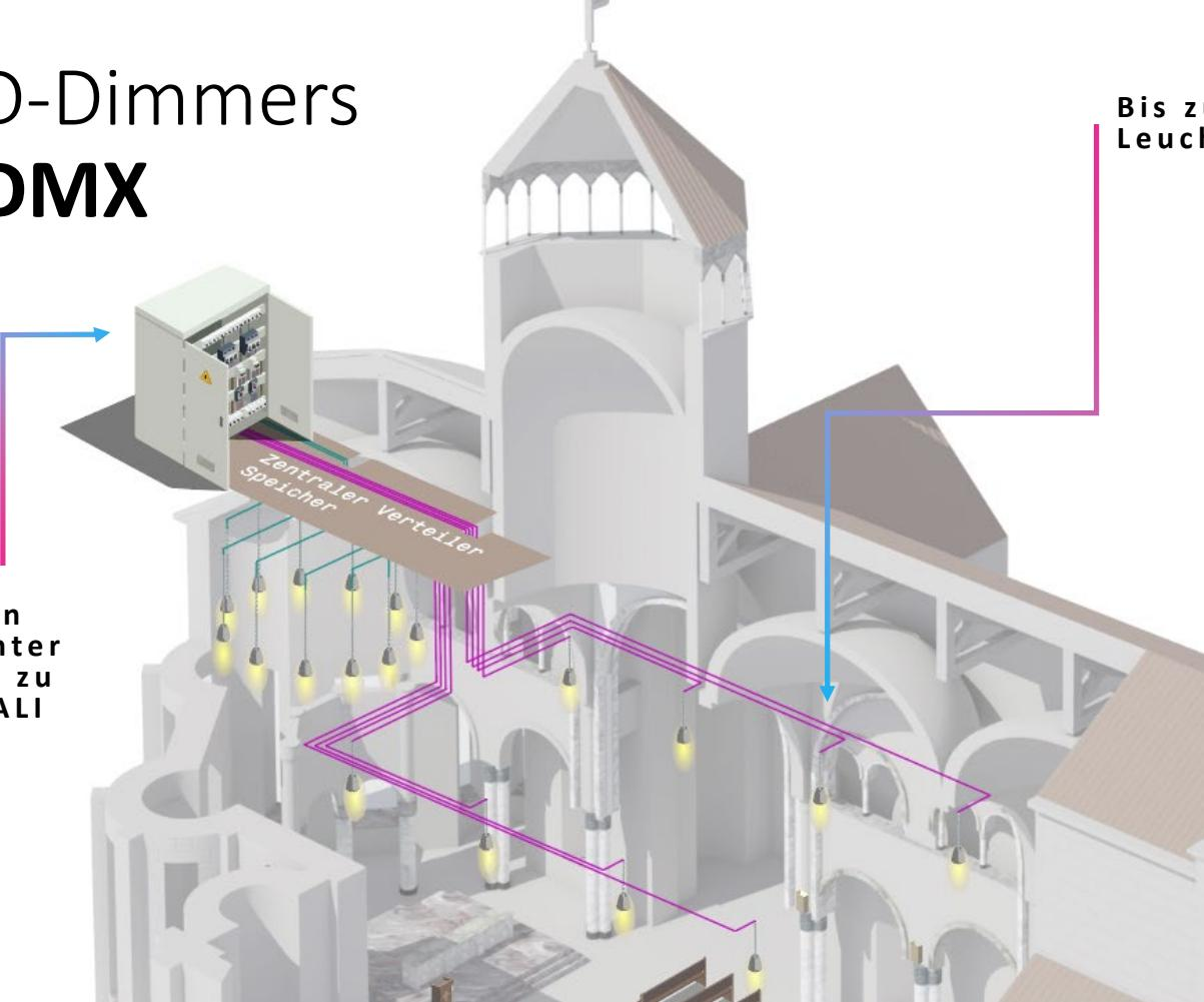
Bis zu 50 Meter von den Leuchten entfernt montierbar
